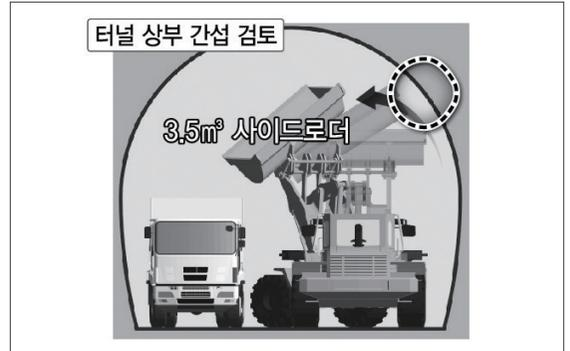
페이로더와 덤프트럭의 교행 및 페이로더의 회전이 동시에 가능하므로 버럭처리 Cycle Time 최소화를 위해 [그림 3.7]과 같이 버럭 처리 순서를 선정하였다.
