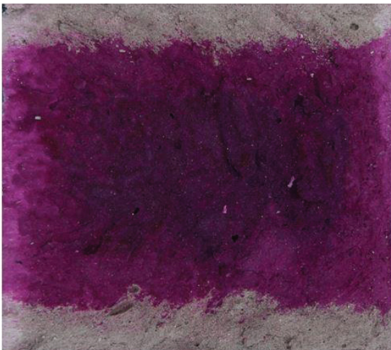
[그림 1] 탄산화된 ECC 깊이 측정
