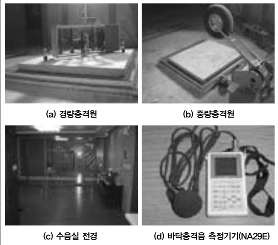
그림 3 | 바닥충격음 발생 및 측정
