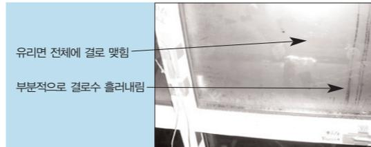
③ 3단계 시험(실외온도 -15 °C / 실내온도 25 °C / 상대습도 50% 2시간 유지)
