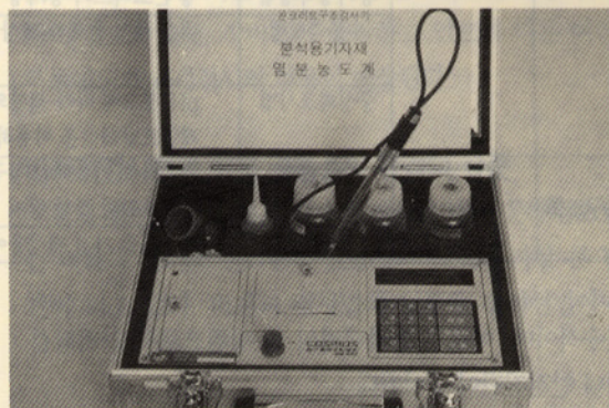
〈사진 2〉 염해조사법중 염분농도계
